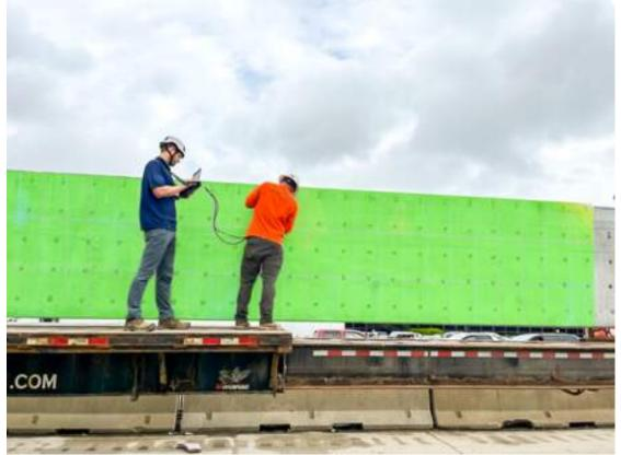
Als Kontrollbereich führte Durability Engineers' UPV auf einem 12 Fuß mal 2 Fuß großen direkten Übertragungsgitter über die Breite des Balkens (1,5 Fuß) durch. Die gemessenen Geschwindigkeiten reichten von 14.865 ft/s bis 16.145 ft/s mit einem Durchschnitt von 15.730 ft/s. Diese direkten UPV-Tests wurden durchgeführt, um die Basisgeschwindigkeit des Betons zu bestimmen und die Messungen für die indirekten UPV-Tests zu kalibrieren.
