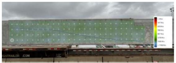
Aus den Ergebnissen ging eindeutig hervor, dass die Geschwindigkeiten im gesamten Messraster ähnlich waren und nicht auf Diskrepanzen oder Schwachstellen hindeuteten. Daher deuten die UPV-Messungen darauf hin, dass der Träger monolithisch verlegt wurde und keine kalte Fuge oder Diskontinuität vorhanden ist.
