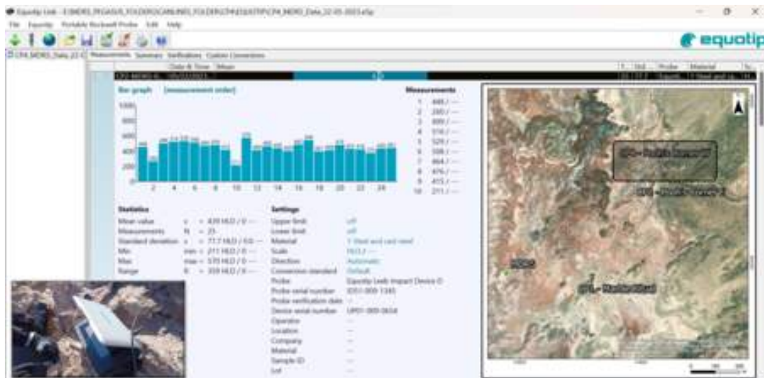
Abb.1: Beispiel für einige der Ergebnisse, die das Equotip-System für die Gesteinshärte in einer der Stationen (25 Messungen pro Station) der Scanline #4 in Pooh's Corner (Westseite), Hanksville (Wüste von Utah, USA) erfasst hat.
