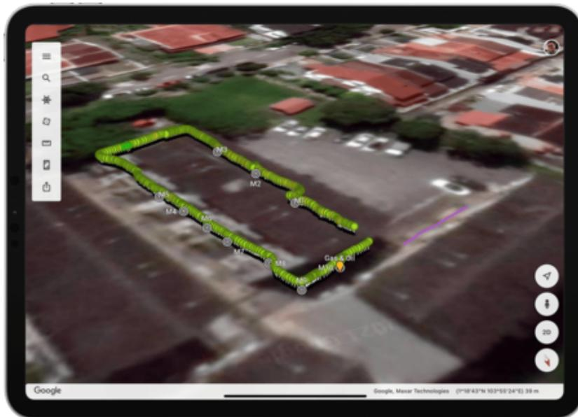
Se escaneó un área de 7 m por 3,5 m con una separación de 0,25 m y se localizó la tubería. El equipo pudo ver la tubería, su dirección y profundidad y visualizarla en realidad aumentada, lo que les permitió comprender su ubicación exacta.
