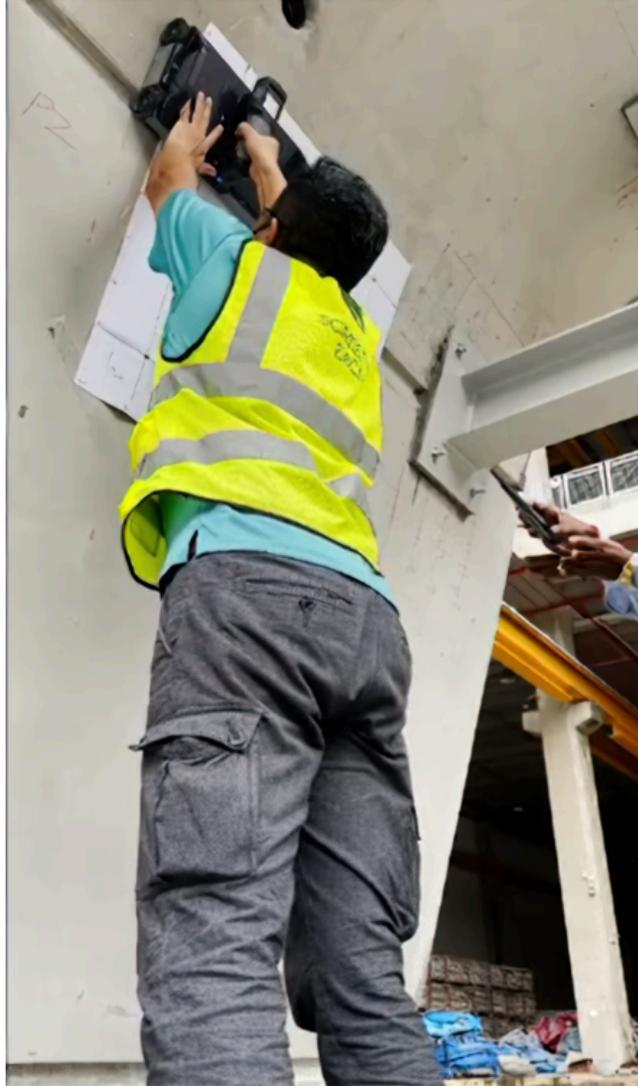
Con el uso de un potente software de recopilación de datos, el [GP8100](#), visualiza los datos 3D en tiempo real y los resultados pueden presentarse en diferentes vistas, como tiempo o como vista de Realidad Aumentada (RA) en el área escaneada. La incrustación de los resultados 2D o 3D en el lugar mediante RA, permite captar la realidad del subsuelo tal como es y crear un informe intuitivo.
