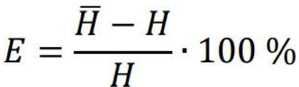
(E - desviación de la medición, 📄 - valor medio de n mediciones, H - valor de referencia, es decir, bloque de prueba)
