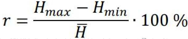
(r-repetibilidad, Hmin y Hmax - los valores de dureza más bajos y más altos respectivamente, 💦 valor medio)
