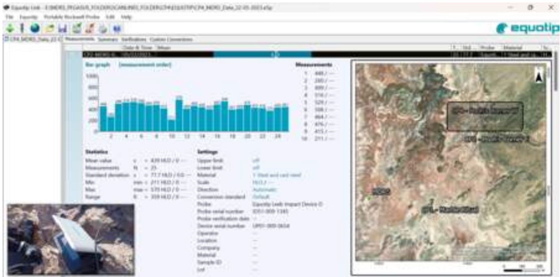
Fig.1 : Exemple de certains des résultats obtenus par l'Equotip rock hardness dans l'une des stations (25 mesures dans chaque station) de la ligne de balayage n°4, située à Pooh's Corner (West side), Hanksville (désert de l'Utah, USA).
