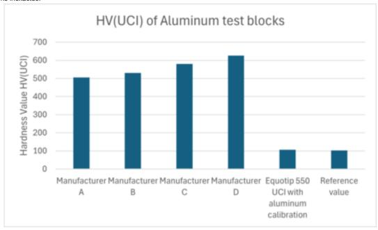
Pour garantir la précision des mesures, des étalonnages spéciaux tenant compte des différents modules de Young sont nécessaires. Les fabricants les fournissent souvent ou les utilisateurs peuvent créer leurs propres étalonnages par le biais d'un étalonnage externe.
