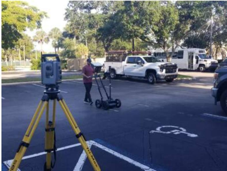
Il Proceq GS8000 vanta un'esclusiva funzione di "percorso libero" che consente al rilevatore di camminare liberamente, senza vincoli di griglia. La risultante heatmap del sottosuolo viene tracciata su una mappa in tempo reale, alla profondità desiderata.
