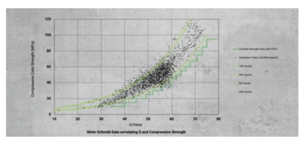
Come per ottenere i risultati delle prove di schiacciamento, anche il metodo del rimbalzo è statistico. Se usato correttamente, consente di ottenere una stima della resistenza del calcestruzzo più affidabile, olistica e molto più conveniente se combinato con alcune prove di schiacciamento.
