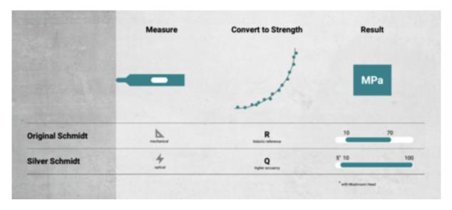
Sì, ci sono, ed è qui che entrano in gioco i martelli a rimbalzo Schmidt per la stima della resistenza e dell'uniformità del calcestruzzo. Abbiamo inventato il principio di Schmidt oltre 60 anni fa e il metodo è completamente non distruttivo.
