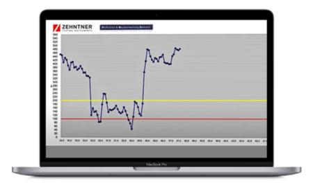
I valori di retroriflessione (RL) sono tracciati in funzione della distanza. I dati reali sono indicati in blu. Sono indicati anche i valori richiesti dalla nostra norma nazionale. Si tratta di 200mcd/m²/lx per la nuova segnaletica orizzontale (colore rosso) e di 100mcd/m²/lx che è il valore minimo richiesto (colore giallo).
