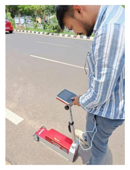
Dotato di touchscreen a colori ad alta risoluzione da 5,7", il retroriflettometro offre un'eccellente visibilità in tutte le condizioni di luce. Il retroriflettometro registra tutte le misure con una precisa geolocalizzazione e fornisce rapidamente rapporti completi con l'aiuto di un software di reportistica facile da usare.
