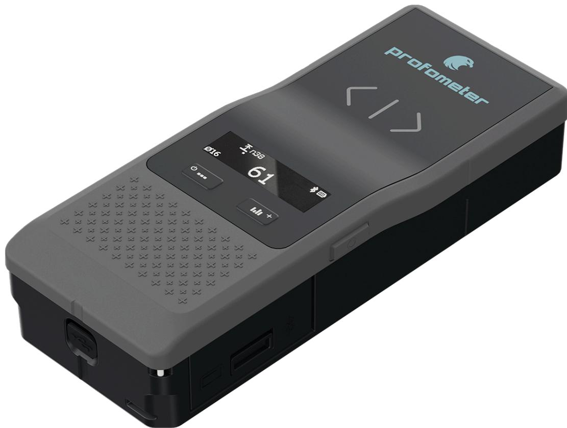
Diâmetro do vergalhão Profometer e medidor de cobertura
