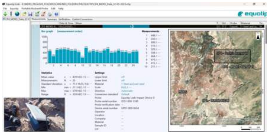
Fig.1: Exemplo de alguns dos resultados obtidos pelo Equotip para a dureza da rocha numa das estações (25 medições em cada estação) da linha de varrimento #4, localizada em Pooh's Corner (lado Oeste), Hanksville (deserto do Utah, EUA).
