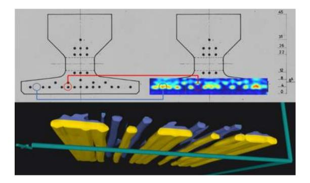
图像中显示了这方面的两个示例 - 蓝色圆圈显示的位置被认为没有预应力钢筋束,但实际上它们存在,而红色圆圈显示的位置 恰恰相反。因此,探地雷达检查可防止在取芯进行实验室评估时损坏结构元件。
