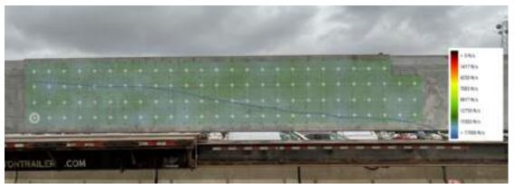
从结果中可以清楚地看出,整个测量网格的速度相似,并不表示存在差异或薄弱区域。因此,UPV 测量表明光束已整体放置, 并未表明存在冷接头或不连续性。
