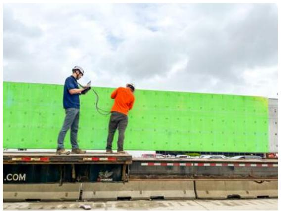
作为控制测试区域,Durability Engineers 在 12 英尺 x 2 英尺直接传输网格上执行了 UPV,穿过光束的宽度(1.5 英尺)。速 度读数范围从 14,865 英尺/秒到 16,145 英尺/秒,平均速度为 15,730 英尺/秒。进行这种直接 UPV 测试以确定混凝土的基线速 度并校准间接 UPV 测试的测量值。
