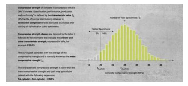
的确,混凝土强度测试的传统方法不是那么简单,而且成本很高。此外,混凝土从来都不是均匀的。如果您在浇筑混凝土时取 样,这些样品不会像真实结构中的混凝土那样放置、压实或固化。同时,现有结构的取芯样本在提取过程中受到干扰。所有这 些因素都会影响估计的强度值。
