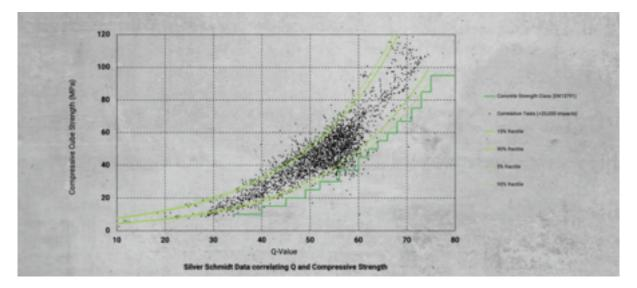
与从碾压试验中获得结果一样,回弹法也是一种统计方法。如果使用得当,当与一些碾压试验相结合时,它可以给你提供更可 靠的、整体的、更具成本效益的混凝土强度估计。
