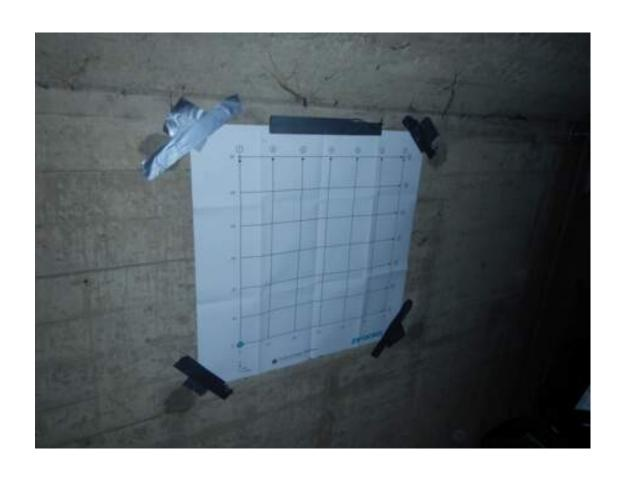
在大多数设备渗透不到的地方,我们的SFCW技术为承包商提供了足够的深度渗透,可检测到深达50厘米的钢筋。GP8000提供了关于后墙的深度和钢筋间距的准确信息,这些结果已经用Ø200的岩芯进行了验证。基于这些信息,承包商向结构工程师提供了足够的信息,以最终确定设计。
