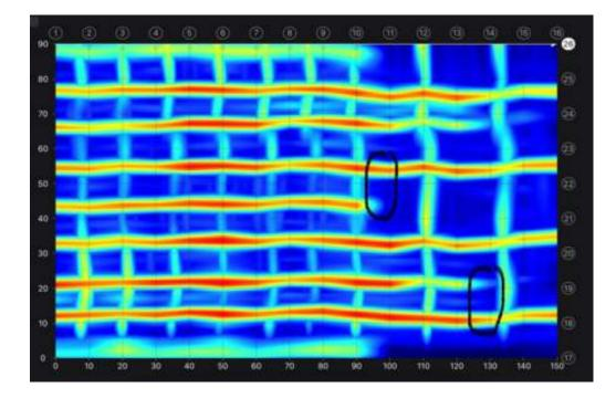
GP8000收集的信息会被纳入计算模型,从而可以确定桥梁的加固配置。
