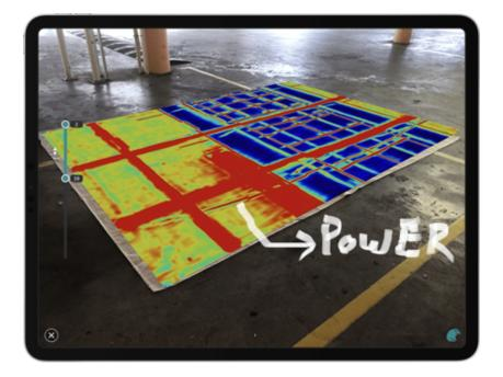
总之, <u>GP8100</u>能够对大面积混凝土进行超快速扫描,并获得易于理解的即时结果。这提高了检验公司和所有项目利益相关者的工作效率和数据可靠性。
