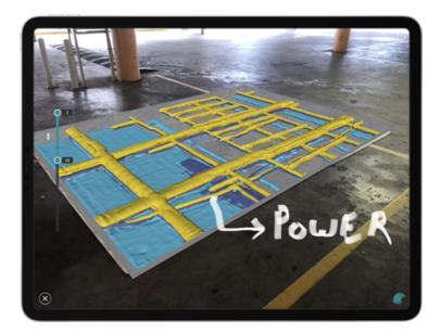
不到5分钟,即完成了包含21条扫描线(包括横向的12条线和纵向的9条线)的大面积区域扫描。用传统的单线扫描方法,即使 是有经验的检测人员也可能需要15-30分钟才能完成。阵列式雷达GP8100的每次扫描实际上是6条线同时进行,这不仅减少了 扫描时间,而且使用户能够获得钢筋和导管布局的即时图像(在"超级线扫"视图内),而不需要通过传统雷达波视图分析。导 管如此明显,即使是经验不足的用户也能找到这个隐蔽的目标。
