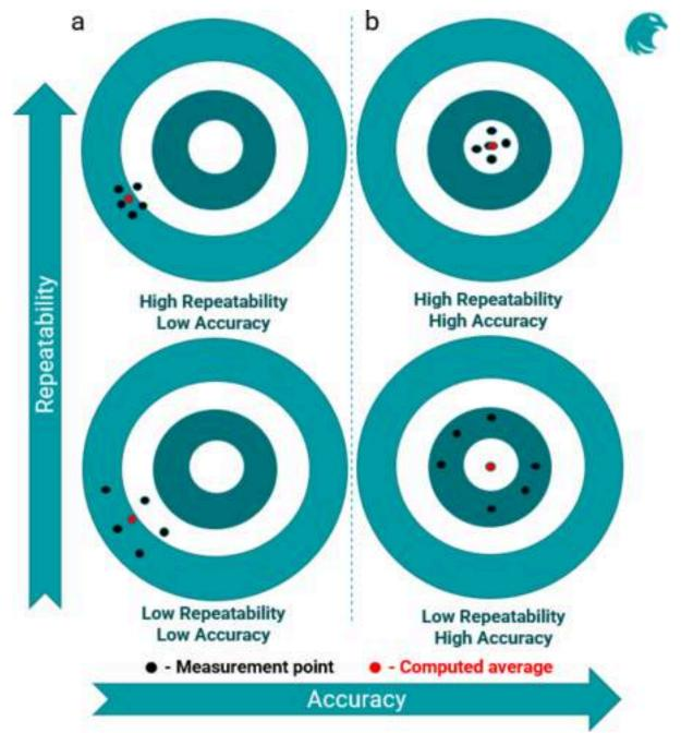
对于许多硬度测试应用来说,这是一个问题,例如,在热影响区 (HAZ) 中,通过收集由单次测量组成的焊缝硬度曲线来检查焊 缝表面硬度。在这种特殊情况下,读数可能会失真,以至于热影响区域和非热影响区域之间的边界不容易被发现或模糊不清。 此外,设备的校准通常是实验室中,在非常受控的环境中以高精度完成的。这最大限度地减少了用户对测量的影响 - 用户在现 场将这些设备用在非理想的表面上,并不总是与被测表面垂直,这一点至关重要。因此,准确但较差重复性的设备给数据的质 量和可靠性增加了不必要的偏差。
